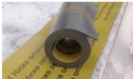
Внешний вид защитно-сигнальной ленты в рулоне и рабочем положении
