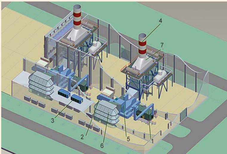
Компоновка основного оборудования ГТУ-ТЭЦ: 1 – ГТУ; 2 – генератор с системой воздушного охлаждения; 3 – АВОВ; 4 – выхлопная труба; 5 – воздухопроводы циклового воздуха и системы воздушного охлаждения; 6 – КВОУ; 7 – котел-утилизатор
