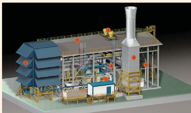
ГПА-32 «Ладога»: 1 – ГТУ MS5002E; 2 – КБОУ; 3 – система охлаждения и вентиляции ГТУ; 4 – система выхлопа; 5 – нагнетатель Н-400-21-1С; 6 – комплексная система автоматического управления; 7 – индивидуальное укрытие ангарного типа
