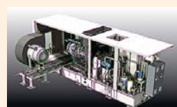
Боковая выкатка силовой турбины из-под кожуха
