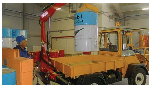
Погрузка металлической бочки при помощи гидравлического крана
