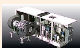
Боковая выкатка всего газотурбинного двигателя из-под кожуха
