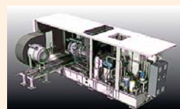
Боковая выкатка силовой турбины из-под кожуха
