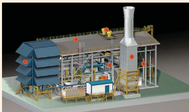
ГПА-32 «Ладога»: 1 – ГТУ MS5002E; 2 – КВОУ; 3 – система охлаждения и вентиляции ГТУ; 4 – система выхлопа; 5 – нагнетатель Н-400-21-1С; 6 – комплексная система автоматического управления; 7 – индивидуальное укрытие ангарного типа
