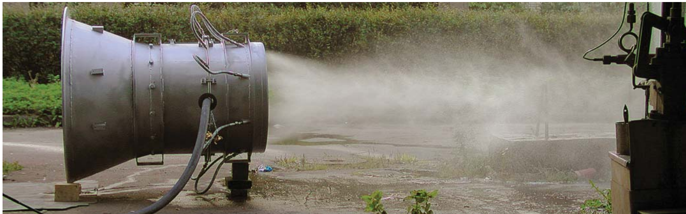
Система промывки Д-336
