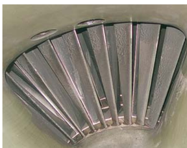
Лопатки до промывки
