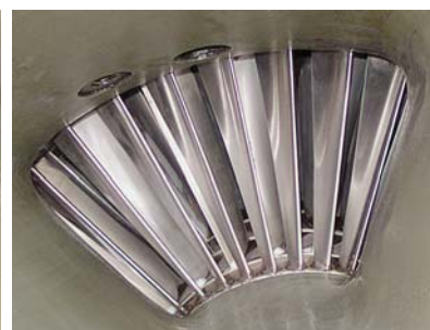
Лопатки после промывки
