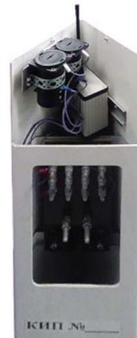
Радиомодуль АСКМ-433 с блоком батарей, размещенные в полости столбика КИП
