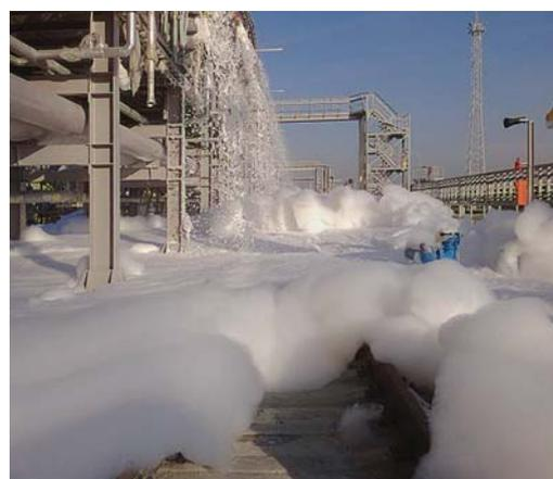
Испытания системы пожаротушения на объекте ТЭК
