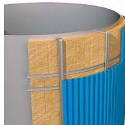
Изоляция резервуара плитами ТЕХ БАТТС:
