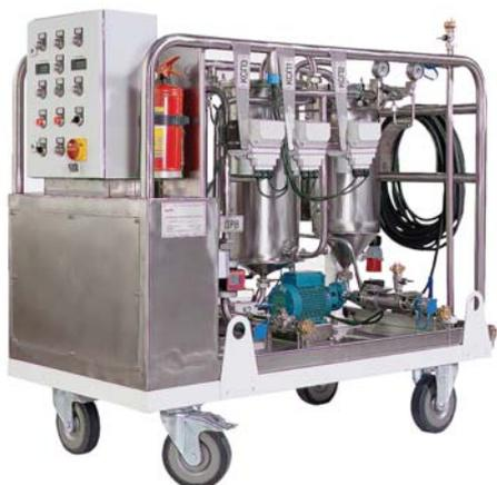
Установка выпускается в общепромышленном (передвижном и стационарном) и взрывозащищенном (передвижном и стационарном) исполнениях. Установка во взрывозащищенном исполнении ОМЭ01-03В имеет маркировку 1Exdes[ia]IIBT4X, соответствует требованиям технического регламента Таможенного союза ТР ТС 012/2011.
