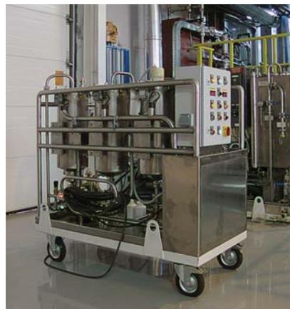
и удаление из него механических примесей субмикронного размера методом электростатической очистки.
