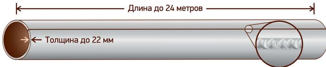
Увеличилась толщина стенки. Теперь можно заказать ТБД из рулонной стали с толщиной стенки до 22 мм.
