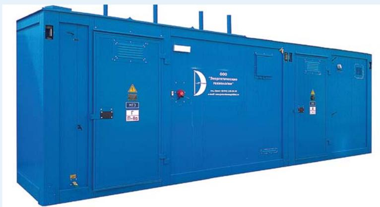
Микротурбинные электростанции (МТЭ) контейнерного исполнения мощностью 15, 30, 65 кВА на базе газотурбинных электроагрегатов Capstone предназначены для использования в качестве основных и резервных источников питания переменного трехфазного тока напряжением 400 (230) В частотой 50 Гц, степень автоматизации не ниже 3 по ГОСТ Р 53174.
